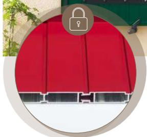
Le tablier en aluminium est composé de lames avec pas de 57,5 mm assemblées par clippage pour une plus grande résistance.
