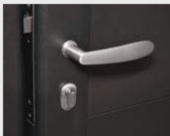
Serrure multifonctions • Ouverture à clé si utilisation avec une gâche électrique • Ouverture avec poignée • Rétractation et condamnation du pêne si ouverture motorisée avec cylindre européen et 3 clés.
