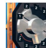
Lors d'une tentative d'effraction, les goupilles **1** sont repoussées dans les gorges **2**. Dans cette position, elles empêchent efficacement la rotation de la poignée de fenêtre à partir de l'extérieur. La poignée se verrouille et déjoue la tentative d'effraction.
